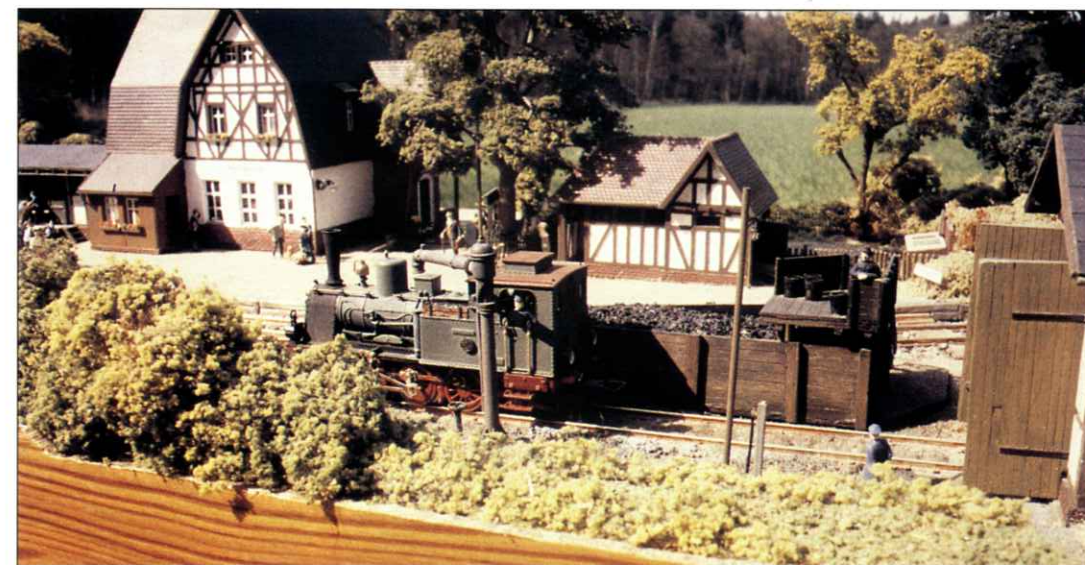
La única locomotora del modelista, una T 3 de Fleischmann reformada y pintada para parecerse a la original.
