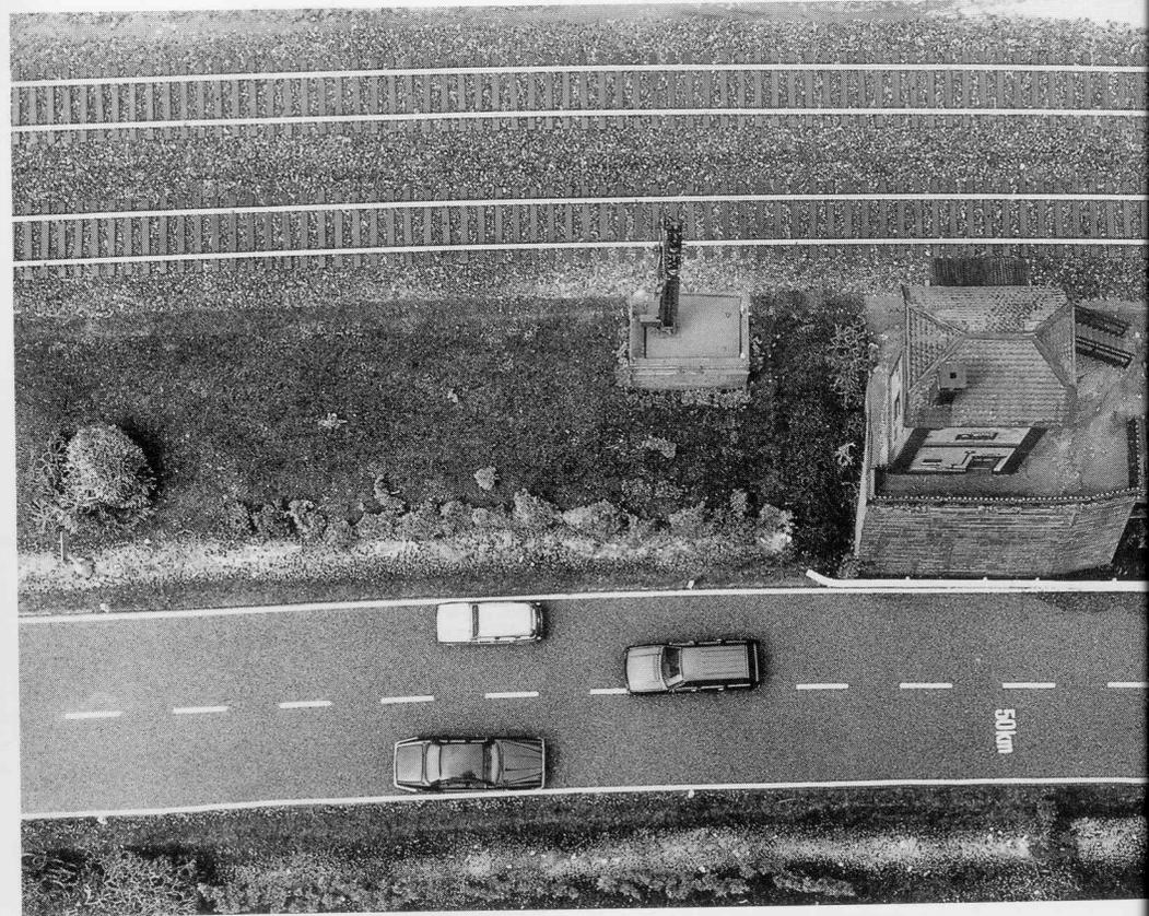
Una carretera de maqueta por debajo de un terraplén. Éste es el aspecto que debería tener una carretera ejemplar: la anchura ha de ser suficiente y en cada lado tiene que haber un arcén y una zanja. Esta carretera de la escala HO se ha construido con forro de Busch, pero también se puede construir de forma «artesanal» siguiendo las instrucciones de este capítulo.
