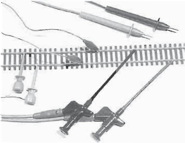
Figura 7.11 Pinzas de comprobación en la vía.
