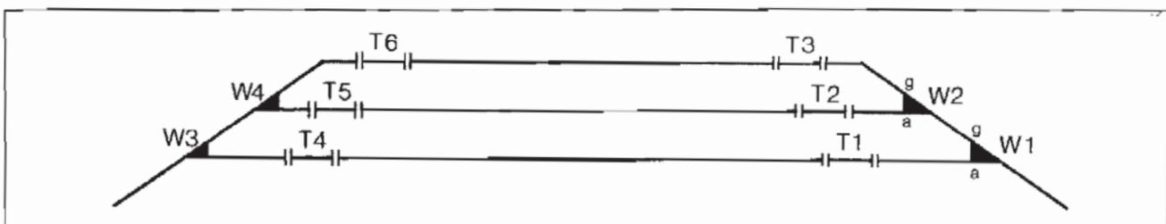
Figura 11.8 El esquema de vías del apartadero falso.
