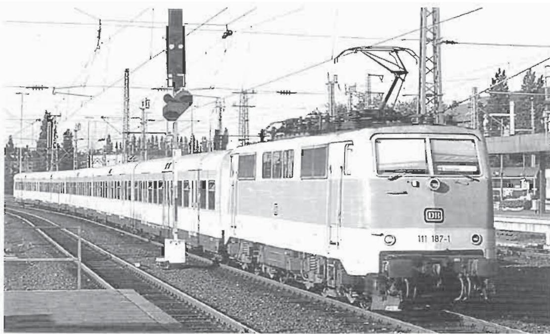
Tensión de tracción 15.000 V  $16 \frac{2}{3}$  Hz
