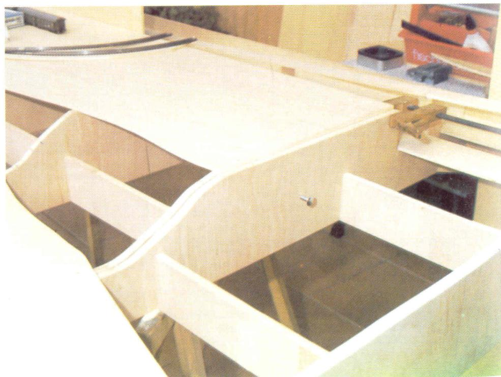
Como se pone de manifiesto en esta fotografía, el método de cuadernas presupone trabajar con gran precisión. Resulta imprescindible disponer de una escuadra de unos 30 cm de largo para marcar y cortar las partes del marco y las tablas de trazados.
