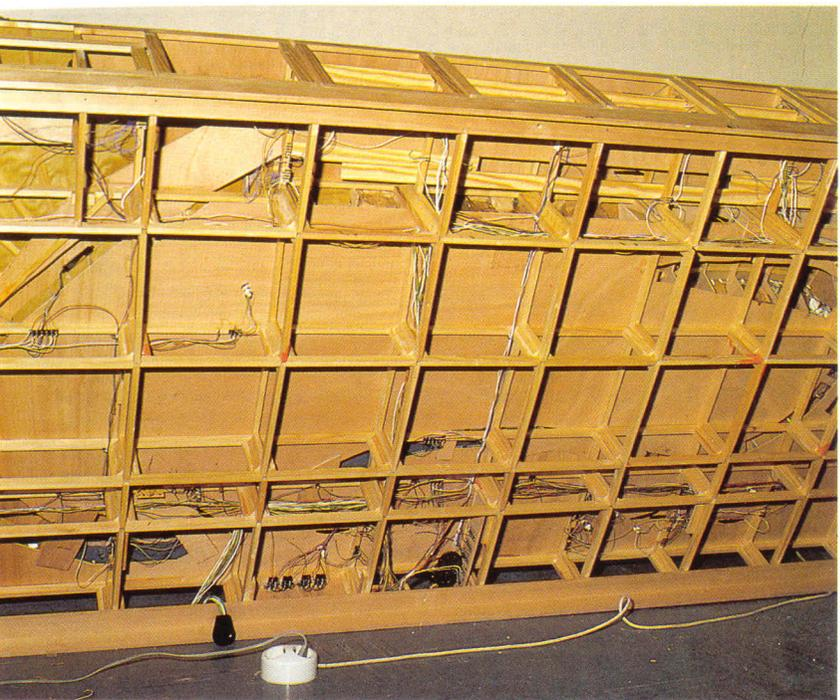
*Las ventajas del método de construcción de las bases a cuadros con listones de madera son su ligereza y la libertad de planificación que ofrecen al modelista. El marco que aparece en la foto ha sido inclinado, con el fin de poder echar un vistazo a su estructura interior. Marcos de este tipo son apropiados para maquetas de las escalas Z hasta H0.*
