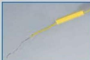
**5.** Jetzt wird das gelbe Stück Schrumpfschlauch auf das gelbe Kabel aufgeschoben.
