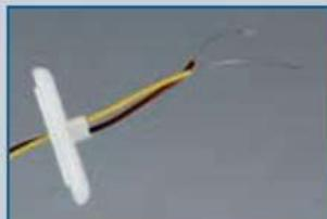
**1.** Die beiden Kabelenden werden durch den milchig-weißen Lampenschirm hindurchgefädelt.
