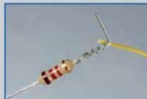
**6.** Das blank Kabelende wird um das waagerechte Ende des beigen Widerstandes gewickelt, ...
