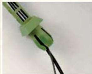
Kabel in den Mast einfädeln
