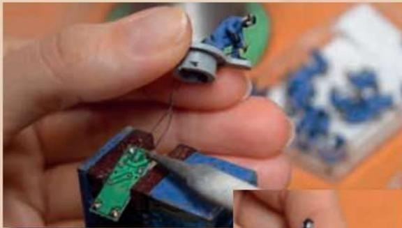
**4.** Die LED wird mit der Platine verbunden, die das charakteristische Flackern steuert.
