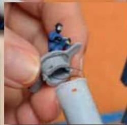
**5.** Die Platine wird durch einen Schrumpfschlauch geschützt (links). Die Figur wird dann auf das Unterflur-Gehäuse gesteckt.
