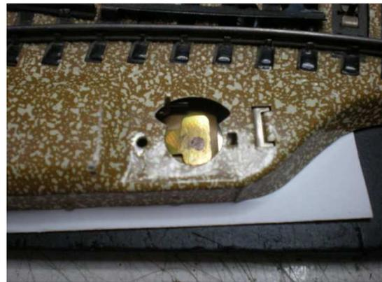
Con el farol desmontado, localizamos la placa de contacto de la bombilla y marcamos en ella el sitio exacto en el que debe quedar el led de 3,5 Mm. ya que si no lo colocamos centrado no permitirá el movimiento libre del cuerpo de la linterna cuando esta gire. Es un trabajo definitivo y sin mantenimiento de por vida.
