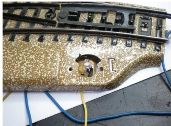
Cortamos las patillas de un led a la medida necesaria para que el cuerpo del led quede dentro del farol, aislamos una patilla del positivo con funda termo retráctil, doblamos la punta y soldamos un cable a la patilla del negativo aislando la soldadura y doblando el cable para que nos entre dentro del cuerpo del desvío sin molestar al mecanismo de este. Soldamos la parte
